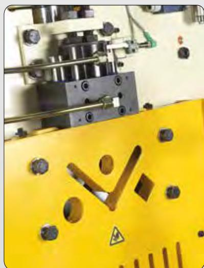
Serre-flan hydraulique de série sur BENDICROP 85 SD
