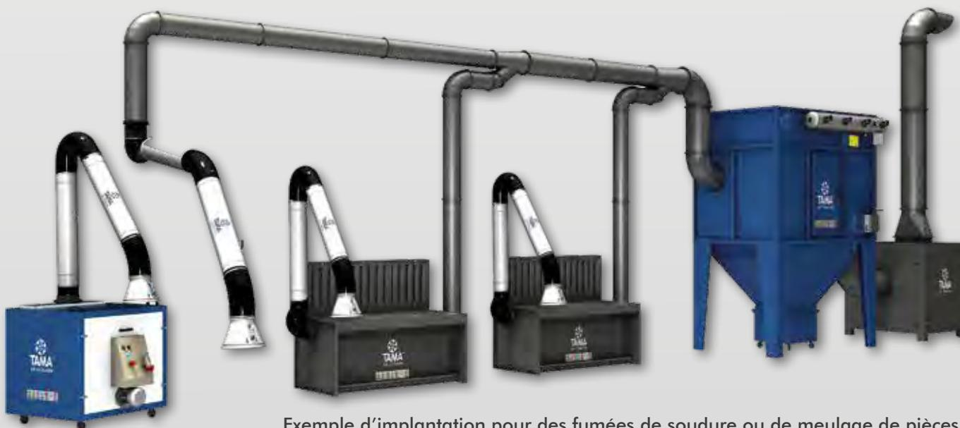
Exemple d'implantation pour des fumées de soudure ou de meulage de pièces. (Filtre a cartouches verticales, table aspirante, bras aspirants, moto-ventilateur)
