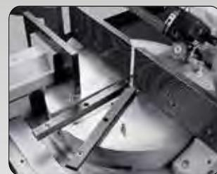
Plateau tournant sur roulement à billes
