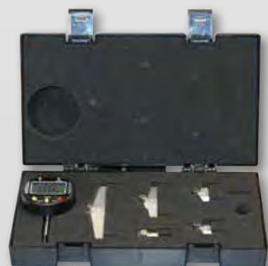
L'ARCHI'MO est fourni dans une mallette en plastique avec une ou plusieurs règles d'étalonnage selon les dimensions des règles à mesure et sa notice d'utilisation. Dans la plupart des cas, notamment par rapport à son coût modique, il remplace avantageusement les gabarits, plus coûteux et peu précis.
