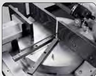
Plateau tournant sur roulement à billes
