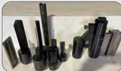
Outils de pliage, poinçonnage et grugeage
